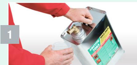
1 Den Messbecher mit ca. 300 ml Reiniger Loctite® 7063 füllen.
