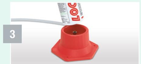
3 Oberteil fest anschrauben und danach die Dose auf die Luftfüllstation setzen. Mit trockener Druckluft befüllen (0,8 MPa / 8 bar / 116 PSI).
