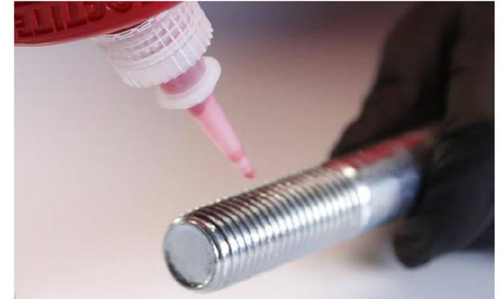
Schraubensicherung ringförmig auf die ersten drei Gewindegänge auftragen (bei Durchgangsbohrungen) bzw. auf den Bohrungsgrund von Sacklochbohrungen.
