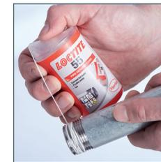
Dichtfaden in Gewinderichtung aufwickeln. Für eine optimale Funktion sollte der Gewindedichtfaden kreuz und quer über die Gewindegänge gelegt werden. Achten Sie darauf, dass Sie den Faden mit Spannung aufwickeln. Schneiden Sie den Gewindedichtfaden LOCTITE 55 mit Hilfe der Schneidvorrichtung ab und drücken Sie das freie Ende in das Gewinde.
